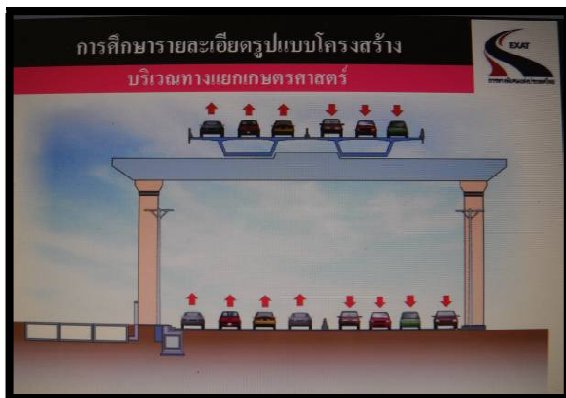
รูปตัดยกระดบโครงสร้าง ยกระดบ 28 เมตร ช่วงผ่านมหาวิทยาลัย โครงสร้างยกระดบคล้ายอุโมงค์ช่วงทางผ่านงามวงศ์วาน-เกษตร
